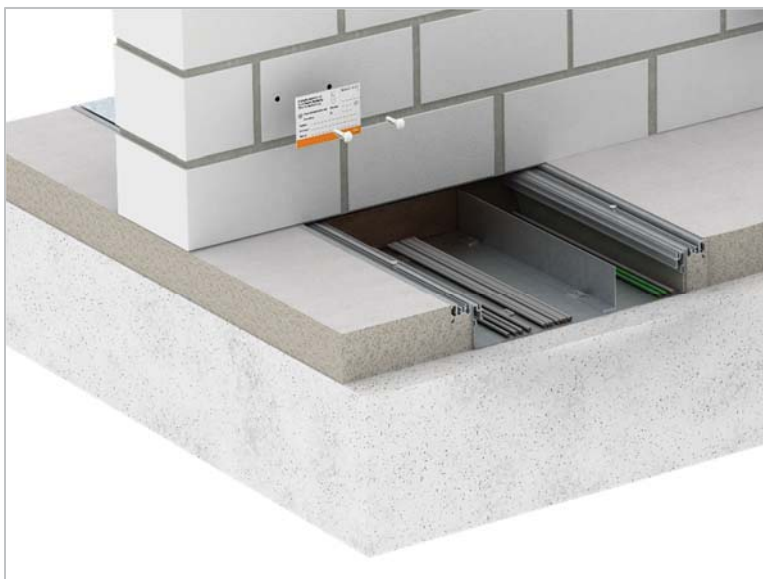
Bild 2: Abschottungsmaßnahme im Bereich der Wandquerung
