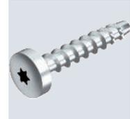
Schraubanker zur direkten Montage ohne Dübel in gerissenem und ungerissenem Beton sowie Mauerwerk. Mit Rundkopf für universelle Befestigungen. Torx-Antrieb T30. Gemäß EAD geprüftes, CE-gekennzeichnetes Bauprodukt mit Europäischer Technischer Bewertung (ETA) und Anwendbarkeitsnachweis. Tragfähigkeiten unter Brandbelastung bis zur Feuerwiderstandsklasse R120 nachgewiesen.
