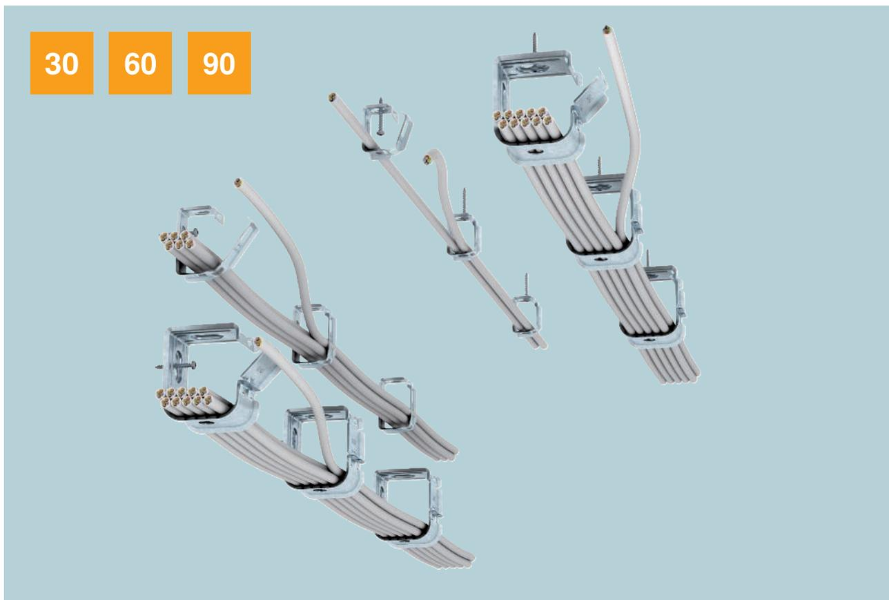
Die geprüften Sammelhalterungen Grip M sind für den Einbau im Zwischendeckenbereich von Flucht- und Rettungswegen geeignet. Die Sammelhalterungen haben im Brandfall eine nachgewiesene mechanische Standsicherheit von 30, 60 und 90 Minuten. Sie können unter der Decke oder an der Wand montiert werden. Die Sammelhalterungen bestehen aus Stahlblech und lassen sich problemlos ohne Werkzeug öffnen und schließen. Während
