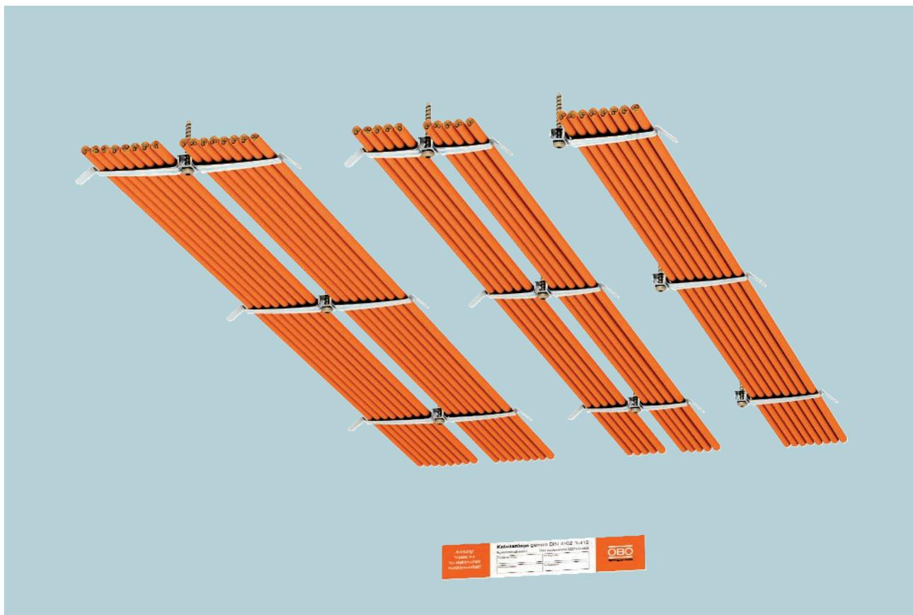
Die Kabelverlegung mit Kabelklammern aus rostfreiem Stahl ist als kabelspezifische Verlegeart nach der DIN 4102 Teil 12 für die Funktionserhaltklasse E 30 zugelassen. Diese Verlegevariante ist ideal, wenn nur wenig Montagehöhe unter der Decke zur Verfügung steht. Mit dem geringen Aufbaumaß können z.B. Brandmeldekabel
