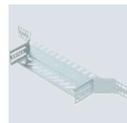
Anbau-Abzweigstück zum Erstellen einer horizontalen Abzweigung oder Kreuzung, Formteil für rast- und schraubbare Kabelrinnen Seitenhöhe 60 mm. Schraubenlose Montage mit Doppelklemmen oder Schraubverbindung mit Flachrundschrauben FRS und Kombimuttern M6. Einsetzbar im Innenbereich. Befestigungsmaterial muss separat bestellt werden.
