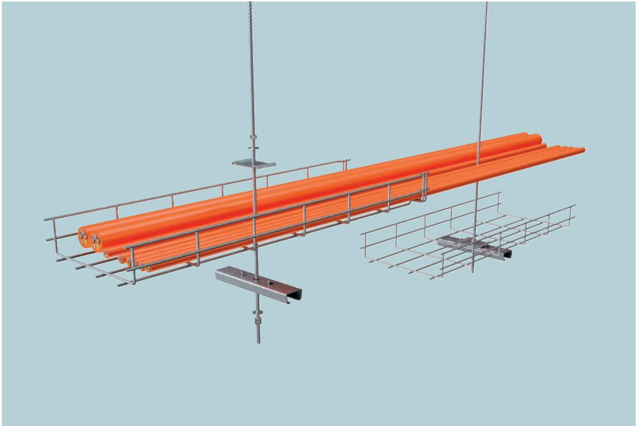
Die Gitterrinne GR-Magic® ist als kabelspezifische Tragkonstruktion für den elektrischen Funktionserhalt nach DIN 4102 Teil 12 geprüft und für die Funktionserhaltklassen E 30 bis E 90 zugelassen. Die Tragekonstruktion als leichtes Verlegesystem besteht aus einer Mittenabhängung und einer zentral angeordneten Gewindestange als
