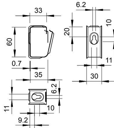
Sammelhalter aus Metall für hohe mechanische Standfestigkeit, auch im Brandfall. Zur sicheren Montage oberhalb von Brandschutzdecken geeignet. Auch als kabelspezifische Variante für den elektrischen Funktionserhalt nach DIN 4102 Teil 12 zugelassen. Für Wand- und Deckenmontage. Verschluss ohne Werkzeuge zu öffnen. Detaillierte Informationen der zugelassenen Verlegevarianten sind den entsprechenden Prüfdocuments zu entnehmen.
