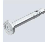
Der Nagelanker N-K ist einsetzbar für Mehrfachbefestigungen nichttragender Systeme in gerissenen und ungerissenen Beton und verbindet die Vorteile eines Bolzenankers mit einer noch einfacheren Montage. Der Nagelanker braucht nur in das Bohrloch eingeschlagen werden. Bei Auftreten der Belastung spreizt der Nagelanker selbstständig und verankert sich im Bohrloch.
