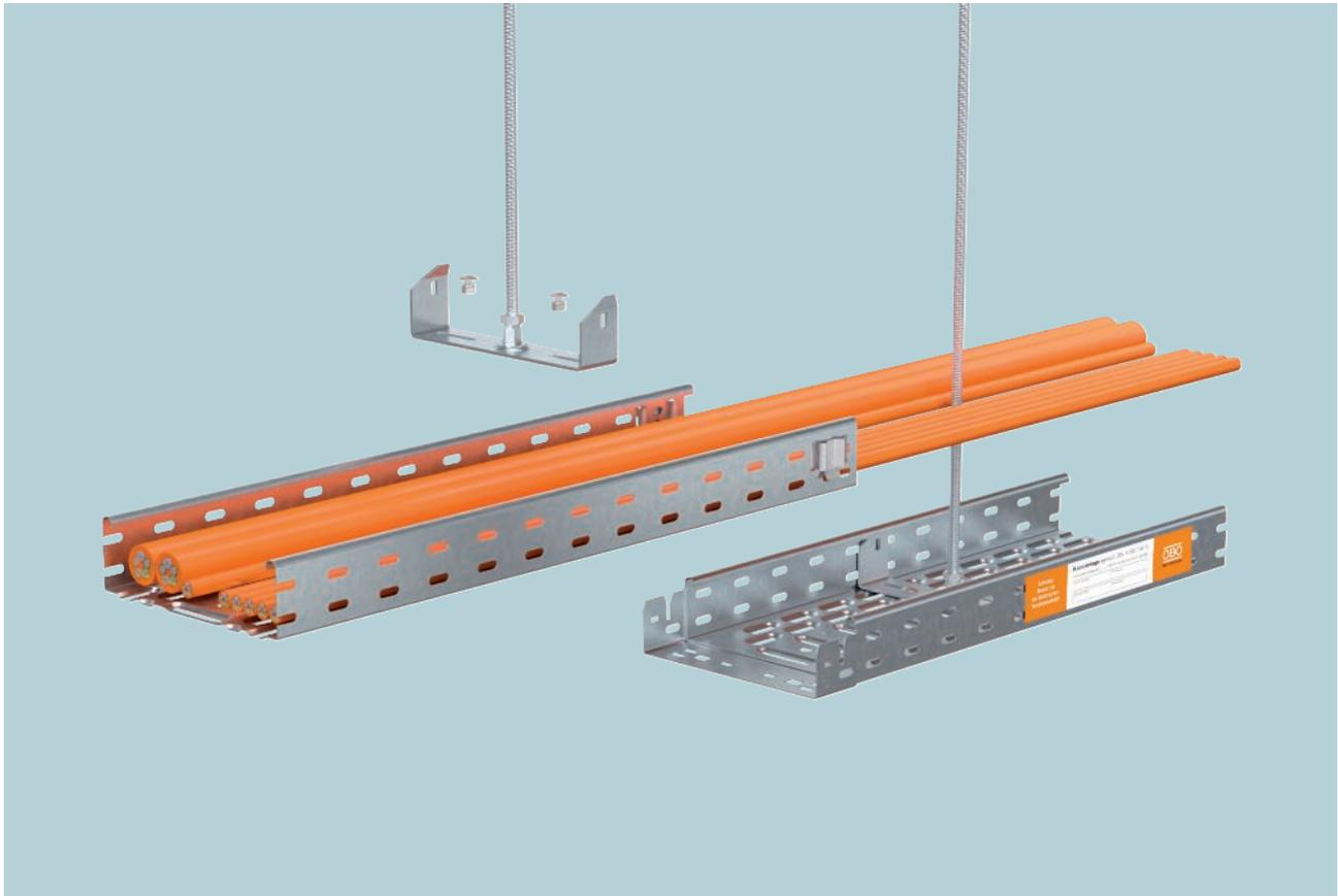
Die Kabelrinne RKS-Magic® ist als kabelspezifische Tragkonstruktion für den elektrischen Funktionserhalt nach DIN 4102 Teil 12 geprüft und für die Funktionserhaltklassen E 30 bis E 90 zugelassen. Die Tragekonstruktion als leichtes Verlegesystem besteht aus einer Mittenabhangung und einer zentral angeordneten Gewindestange als Abhangebauteil, und lasst sich einfach, schnell und mit nur wenigen Bauteilen installieren. Mit dem schraubenlosen Stecksystem lassen sich die Kabelrinnen RKS-Ma-
