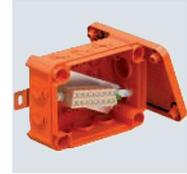
Verbindungskasten für Datentechnik mit weichen Einsteckdichtungen. Paarige Anzahl der hohtemperaturbeständigen Keramikklemmen passend zu Datenleitungen. Grün-gelb gekennzeichnete Schutzleiter-/Schirmklemme. Befestigung an gut zugänglichen Außenlaschen. Zugelassen für Kabelanlagen mit elektrischem Funktionserhalt nach DIN 4102 Teil 12 mit den Klassen E30, E60 und E90. Keramikklemmen wurden nach DIN EN 60998-2-1:2004 geprüft.
