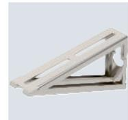
Abhängewinkel zur Wandmontage von Kabelrinnen, Gitterrinnen und Kabelleitern speziell in Tunnelbauten. Geprüft nach DIN 4102-12.
