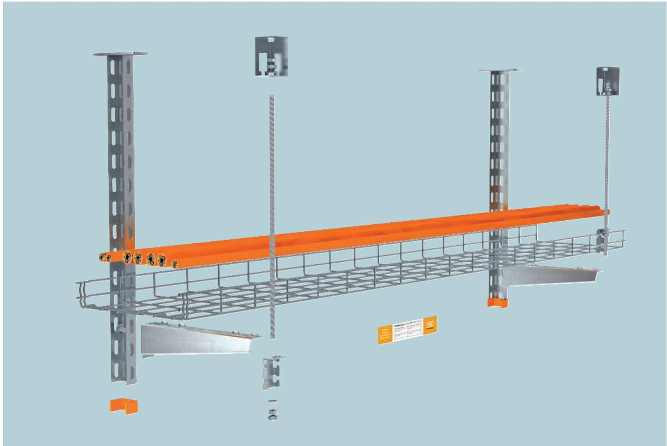
Die Gitterrinne GR-Magic® ist als kabelspezifische Tragkonstruktion für den elektrischen Funktionserhalt nach DIN 4102 Teil 12 geprüft und für die Funktionserhaltklassen E 30 bis E 90 zugelassen. Die Montage der Gewindestangensicherung erfolgt direkt am Rinnenholm mit dem Anschlussbauteil ABG. Dieses wird nur auf die seitlichen Längsdrähte der Gitterrinne aufgesteckt. Nach Mon-
