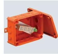
Kabelabzweigkasten mit keramischen Doppelklemmen und weichen Einsteckdichtungen. Ausreichender Verdrahtungsraum durch diagonal angeordnete Anschlusseinheit mit komplett vormontierten hochtemperaturbeständigen Keramikklemmen. Grün-gelb gekennzeichnete Schutzleiterklemme. Befestigung an gut zugänglichen Außenlaschen. Zugelassen für Kabelanlagen mit elektrischem Funktionserhalt nach DIN 4102 Teil 12 mit den Klassen E30, E60 und E90. Keramikklemmen wurden nach DIN EN 60998-2-1:2004 geprüft.
