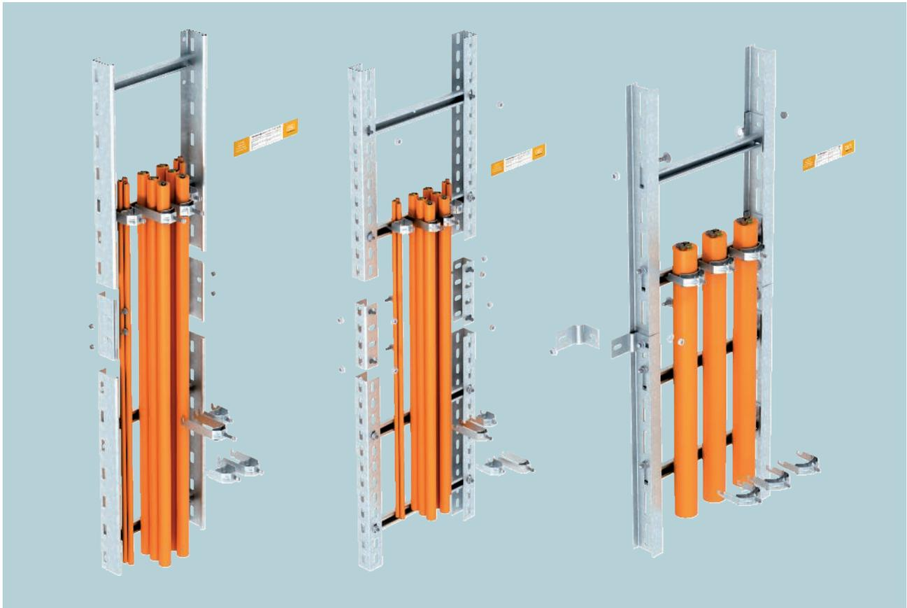
Steigeleitern vom Typ LG, Typ SLM und Typ SLS erfüllen alle Forderungen der DIN 4102 Teil 12 als Normtragekonstruktion für die Funktionserhaltungsklassen E30, E60 und E90. Sie sind in den Breiten 200 bis 400 mm (Typ LG) und in den Breiten 400 bis 600 mm (Typ SLM und Typ SLS) erhältlich. Die Steigeleitern bestehen aus Längsprofilen mit vernieteten bzw. verschraubten Sprossen. Der Abstand der Sprossen beträgt 30 cm.
