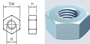
Sechskantmutter nach DIN 934 mit metrischem Gewinde. Festigkeitsklasse 8.8.
