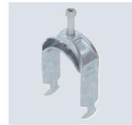
Bügelschelle mit Hammerkopf-Fuß, Metalldruckwanne mit gerundeten Kanten für Kabelschutz. Zur vertikalen und horizontalen Montage von 1 Einzelkabel an C-Profilschiene. Für Schlitzweite 16 - 17 mm. Mit 1-gängiger Schraube an Druckwanne, universeller Sechskant-Schraubenkopf SW10, mit Schlitz und Kreuzschlitz. Geeignet für Montage im Innen- und Außenbereich. Gegenwanne muss separat bestellt werden.
