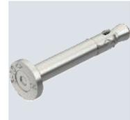
Der Nagelanker N ist einsetzbar für Mehrfachbefestigungen nichttragender Systeme im Innen- und Außenbereich in gerissenen und ungerissenen Beton und verbindet die Vorteile eines Bolzenankers mit einer noch einfacheren Montage. Der Nagelanker braucht nur in das Bohrloch eingeschlagen werden. Bei Auftreten der Belastung spreizt der Nagelanker selbstständig und verankert sich im Bohrloch.
