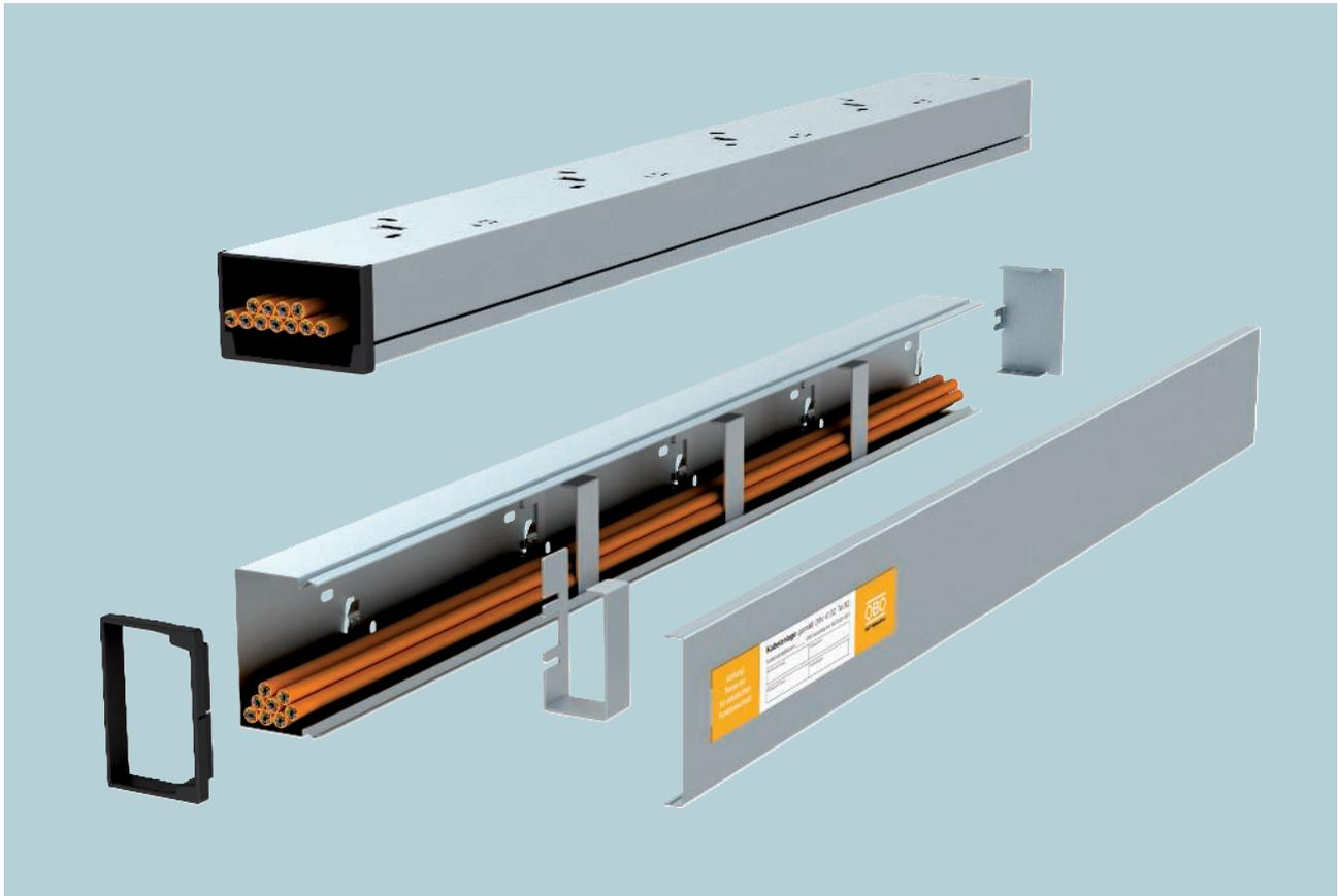
Die Kabelverlegung mit Leitungsführungskanälen aus Metall Typ LKM ist als kabelspezifische Verlegeart nach der DIN 4102 Teil 12 für die Funktionserhaltklassen E 30, E 60 und E 90 zugelassen. Die Kanäle dürfen waagrecht an der Wand oder unter der Decke verlegt werden und bieten einen zusätzlichen mechanischen Schutz der installierten Kabel. Ebenfalls zum Einsatz kommt diese Installationsvariante, wenn aus optischen Gründen eine
