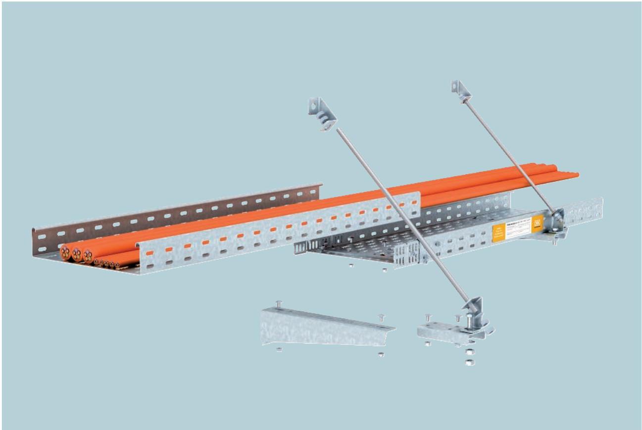
Die Verlegeart von Kabelrinnen des Typs SKS mit Wandauslegern an der Wand erfüllt alle Forderungen der DIN 4102 Teil 12 als Normtragkonstruktion für die Funktionserhaltklassen E 30 bis E 90. Bei Montage der Kabelrinnen an der Wand können bis zu drei Lagen der Rinnen übereinander angeordnet werden. Die Befestigung der Gewindestangensicherung senkrecht zur Decke erfolgt mit einem unter dem Rinnenboden verschraubten Anschlussbauteil ABR in einem Abstand von max. 100 mm neben
