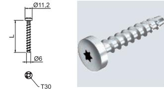
Schraubanker zur direkten Montage ohne Dübel in gerissenem und ungerissenem Beton sowie Mauerwerk. Mit Rundkopf für universelle Befestigungen. Torx-Antrieb T30. Gemäß EAD geprüfetes, CE-gekennzeichnetes Bauprodukt mit Europäischer Technischer Bewertung (ETA) und Anwendbarkeitsnachweis. Tragfähigkeiten unter Brandbelastung bis zur Feuerwiderstandsklasse R120 nachgewiesen.
