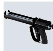
Hochwertige 2-Komponenten-Kartuschenpistole für den Einsatz mit dem PYROSIT® NG Brandschutzschaum. Die Parallelbewegung des Abzugs zum Haltegriff sorgt für ermüdungsfreies Arbeiten. Geeignet für 5:1-Koaxialkartuschen. Die beweglichen Teile, Schubstangen und Druckplatte, sind von eventuellen Schaumrückständen zu befreien und mit einem rückfettenden Reiniger zu pflegen.
