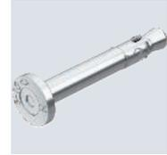
Der Nagelanker N-K ist einsetzbar für Mehrfachbefestigungen nichttragender Systeme in gerissenen und ungerissenen Beton und verbindet die Vorteile eines Bolzenankers mit einer noch einfacheren Montage. Der Nagelanker braucht nur in das Bohrloch eingeschlagen werden. Bei Auftreten der Belastung spreizt der Nagelanker selbstständig und verankert sich im Bohrloch.
