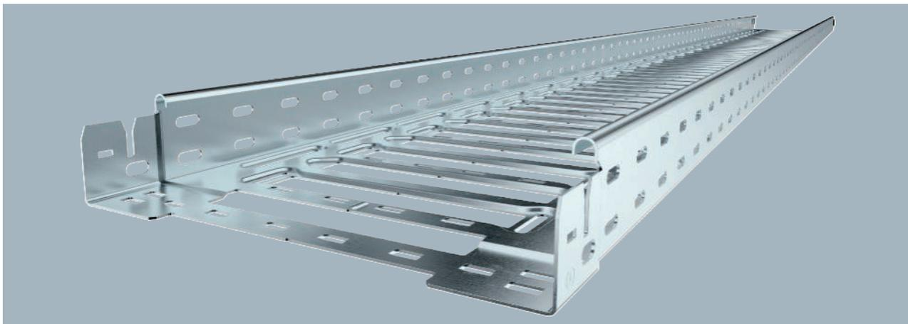
Kabelrinne mit integriertem Schnellbefestigungssystem. Die Nutzlänge der Kabelrinne beträgt 3.000 mm. Die Kabelrinne verfügt über eine durchgängige Seitenlochung von 7 x 20 mm für die Installation zusätzlicher Verbindungs- und Montagebauteile. Ab Kabelrinnenbreite 200 mm mit 30% Lochanteil, nach VdS Richtlinie 2092 zum Einsatz unter Sprinkleranlagen geeignet.
