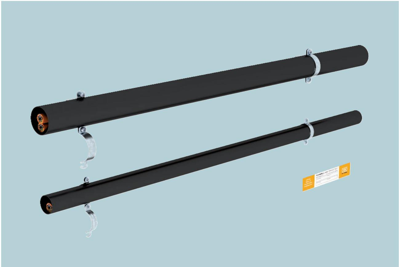
Die Kabelführung im Stahlrohr in Kombination mit Bügelschellen bzw. mit Schraubabstandschellen erfüllt die Anforderungen der DIN 4102 Teil 12 als kabelspezifische Verlegeart für die Funktionserhaltklassen E 30, E 60 und E 90. Die Stahlrohre dürfen waagrecht an der Wand oder unter der Decke verlegt werden und bieten einen zusätzlichen mechanischen Schutz der installierten Kabel. Verwendet werden Bügelschellen aus Stahlblech mit einer
