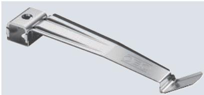
Die Kabelklammer aus Metall ist halogen- und brandlastfrei und bietet auch im Brandfall hohe mechanische Standfestigkeit. Die Kabelklammer ist als kabelspezifische Variante für den elektrischen Funktionserhalt gem. DIN 4102 Teil 12 zugelassen. Das Distanzstück 2033 D 15 x 3 G (separat zu bestellen) vergrößert bei Kabelklammern die Klemmhöhe von 10 auf 13 mm. Die Kabelklammer eignet sich zur brandsicheren Montage oberhalb abgehängter Brandschutzdecken nach DIN 4102.
