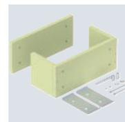
Zugentlastung als wirksame Unterstützungsmaßnahme für senkrechte Kabelverlegung nach DIN 4102 Teil 12. Zugelassen für alle Kabeltypen und Steigeleitern, die als hängende Montage ausgeführt werden. Funktionserhaltklassen E30 bis E90. Leeres Gehäuse zur individuellen Füllung mit Brandschutzschaum PYROSIT® NG und/oder Schaumstoffblöcken PYROPLUG® Block, inkl. Montageset und Kennzeichnungsschild.
