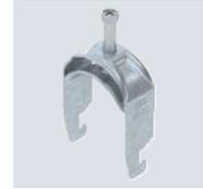
Bügelschelle mit U-Fuß, Metalldruckwanne mit gerundeten Kanten für Kabelschutz. Zur vertikalen und horizontalen Montage von 1 Einzelkabel an C-Profilschiene. Für Schlitzweite 18 - 22 mm. Mit 1-gängiger Schraube an Druckwanne, universeller Sechskant-Schraubenkopf SW10, mit Schlitz und Kreuzschlitz. Geeignet für Montage im Innen- und Außenbereich. Der Einsatz einer Gegenwanne wird empfohlen.
