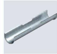
Zur Vergrößerung der Auflagefläche für Kabel mit integriertem Funktionserhalt wird zusätzlich zur Bügelschelle noch eine Langwanne (L = 200 mm) montiert.
