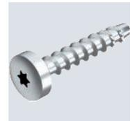
Schraubanker zur direkten Montage ohne Dübel in gerissenem und ungerissenem Beton sowie Mauerwerk. Mit Rundkopf für universelle Befestigungen. Torx-Antrieb T30. Gemäß EAD geprüfetes, CE-gekennzeichnetes Bauprodukt mit Europäischer Technischer Bewertung (ETA) und Anwendbarkeitsnachweis. Tragfähigkeiten unter Brandbelastung bis zur Feuerwiderstandsklasse R120 nachgewiesen.
