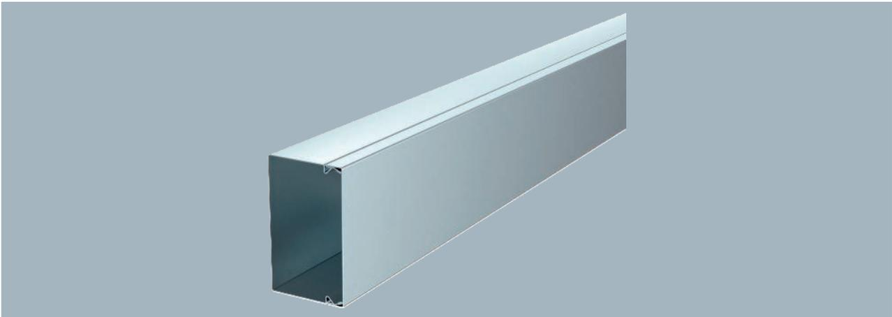
Kanaloberteil und -unterteil mit Bodenlochung. Der Potentialausgleich ist ohne weitere Hilfsmittel zwischen Unter- und Ober- teil gewährleistet. Der LKM Leitungsführungskanal Typ LKM 60100 ist als Verlegesystem für Funktionserhalt nach DIN 4102 Teil 12 geprüft. Bitte beachten Sie die im Bereich BSS Brand- schutz-Systeme geprüften Kabeltypen!
