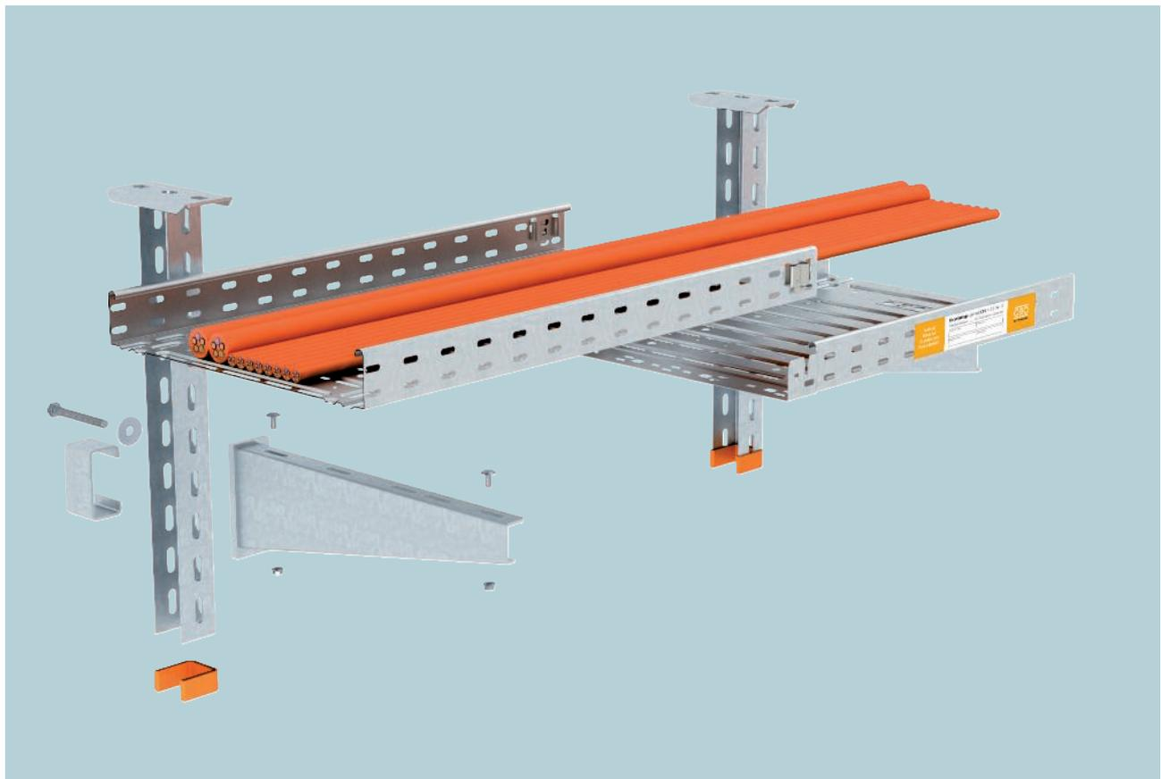
Die Kabelrinne RKS-Magic® ist als kabelspezifische Tragkonstruktion für den elektrischen Funktionserhalt nach DIN 4102 Teil 12 geprüft und für die Funktionserhaltklassen E 30 bis E 90 zugelassen. Eine Gewindestangensicherung an der Auslegerspitze ist nicht erforderlich. Dadurch wird nicht nur Material eingespart, die Installation von Kabeln wird auch deutlich vereinfacht und beschleunigt. Mit dem schraubenlosen Stecksystem lassen sich die Kabelrinnen RKS-Magic® werkzeuglos und dadurch
