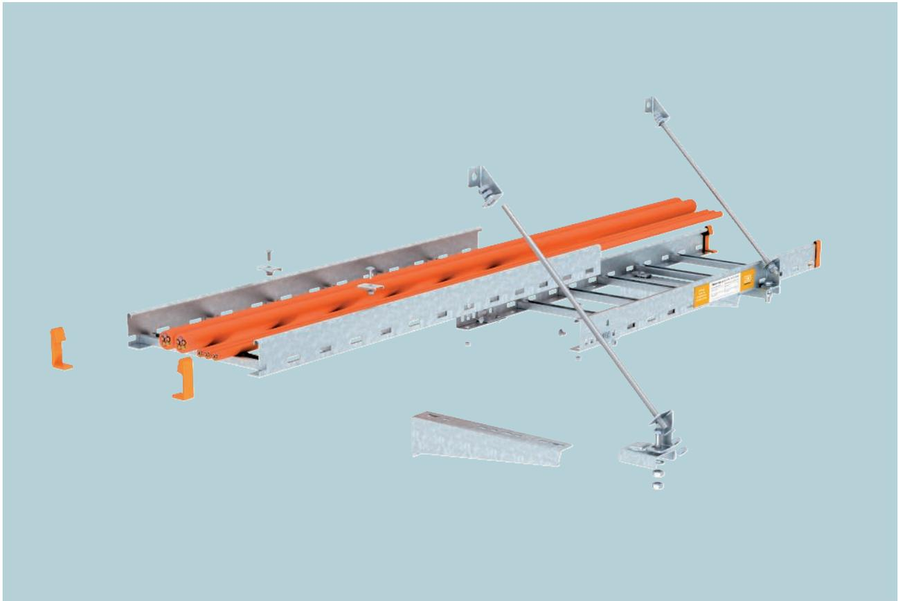
Die Verlegeart von Kabelleitern des Typs LG mit Wandauslegern an der Wand erfüllt alle Forderungen der DIN 4102 Teil 12 als Normtragkonstruktion. Bei Wandmontage der Kabelleitern können bis zu zwei Lagen übereinander angeordnet werden. Die senkrechte Befestigung der Gewindestangensicherung zur Decke erfolgt schraubenlos durch den auf dem Untergurt des Leiterholms aufge-
