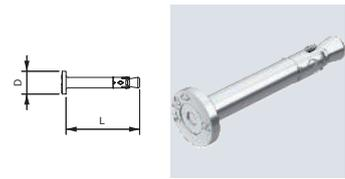
Der Nagelanker N-K ist einsetzbar für Mehrfachbefestigungen nichttragender Systeme in gerissenen und ungerissenen Beton und verbindet die Vorteile eines Bolzenankers mit einer noch einfacheren Montage. Der Nagelanker braucht nur in das Bohrloch eingeschlagen werden. Bei Auftreten der Belastung spreizt der Nagelanker selbstständig und verankert sich im Bohrloch.
