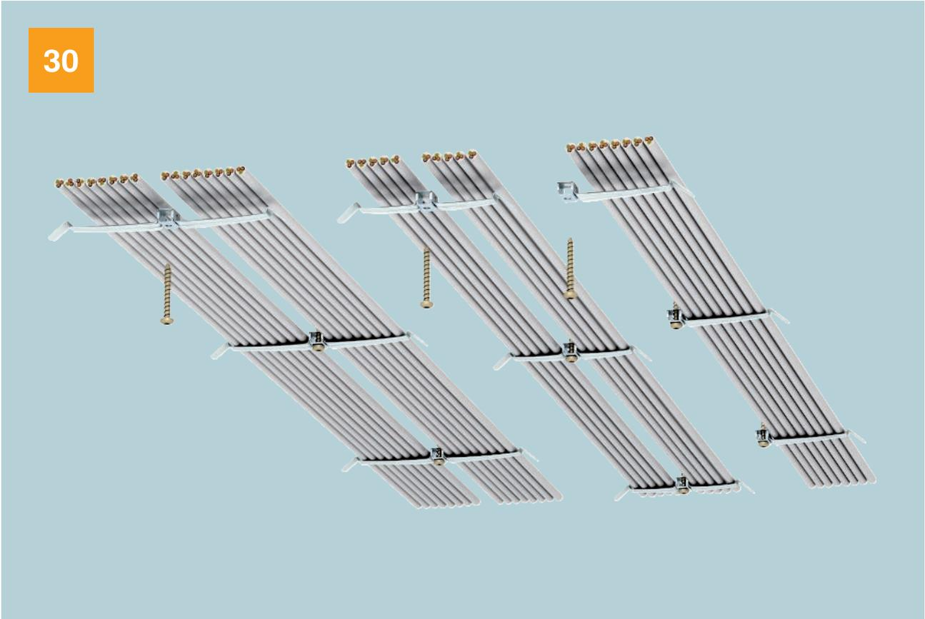
Die geprüften Kabelklammern sind für den Einbau im Zwischendeckenbereich von Flucht- und Rettungswegen geeignet. Die Kabelklammern haben im Brandfall eine nachgewiesene mechanische Standsicherheit von 30 Minuten. Sie werden unter der Decke montiert. Die Kabelklammern bestehen aus federndem, rostfreiem Stahl. Zum Installie-
