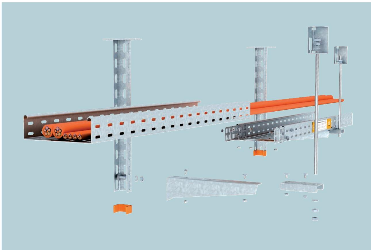
Die Verlegeart unter der Decke von Kabelrinnen der Typen SKS mit U-Hängestielen und SKS auf U-Querprofilen erfüllt alle Forderungen der DIN 4102 Teil 12 als Normtragkonstruktion für die Funktionserhaltklassen E 30 bis E 90.
