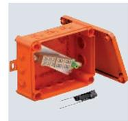
Kabelabzweigkasten mit einem Sicherungshalter und weichen Einsteckdichtungen. Ausreichender Verdrahtungsraum durch diagonal angeordnete Anschlusseinheit mit komplett vormontierten hochtemperaturbeständigen Keramikklemmen. Grün-gelb gekennzeichnete Schutzleiterklemme. Befestigung an gut zugänglichen Außenlaschen. Zugelassen für Kabelanlagen mit elektrischem Funktionserhalt nach DIN 4102 Teil 12 mit den Klassen E30, E60 und E90. Keramikklemmen wurden nach DIN EN 60998-2-1:2004 geprüft.
