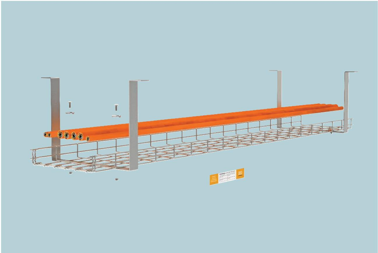
Die Gitterrinne GR-Magic® aus rostfreiem Stahl ist als kabelspezifische Tragkonstruktion für den elektrischen Funktionserhalt nach DIN 4102 Teil 12 geprüft und für die Funktionserhaltklassen E 30 bis E 90 zugelassen. Die Ausführung aus rostfreiem Stahl lässt eine Montage in Bereichen mit aggressiveren Umgebungsbedingungen zu. Der Abhängebügel AHB-T kann durch seine Bauform an geraden und schrägen oder gebogenen Decken montiert werden und ermöglicht so eine einfache und platzsparen-
