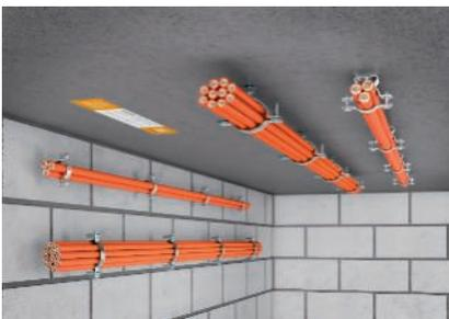
Gebündelte Kabelverlegung unter der Decke.
