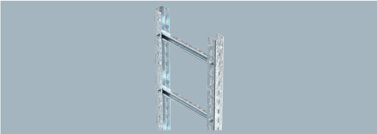
Schweres Steigeleiter-System für den elektrischen Funktionserhalt nach DIN 4102 Teil 12. Zugelassene Schellen Typ BS-U1-M... FT. Lieferung erfolgt unmontiert.
