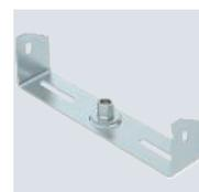
Die Mittenabhängung verfügt über eine drehbar angeordnete Gewindehülse M10. Bei der Belegung bitte auf gleichmäßige Verteilung der Last achten (einseitige Belegung vermeiden). Die Breiten 100, 150 und 200 mm haben zusätzliche Bodenlochanlagen, um die Mittenabhängung bei Verwendung für den Funktionserhalt gemäß DIN 4102 Teil 12 mit dem Rinnenboden verschrauben zu können. Mittenabhängung für Kabelrinnen mit eingerolltem Seitenholm in der Seitenhöhe 60 mm.
