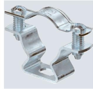
Abstandschelle zur Montage von Röhren und Kabeln an Wand, Decke und Boden. Mit selbstsicherndem Oberteil. Befestigung über Langloch.
