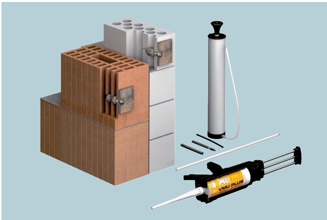
Das Injektionsmörtel-System VMU Plus ist besonders geeignet für die Befestigung in Hochlochziegeln, Beton und Porenbeton, Kalksandstein, Kalksandlochstein und Mauerziegeln. Die Verbindung ist spreizdruckfrei und erfolgt durch Formschluss des Injektionsmörtels mit dem Untergrund und einer Ankerstange. Geprüft und zugelassen sind die Komponenten für eine Feuerwiderstandsdauer von 90 Minuten. In Abhängigkeit von der Feuerwiderstandsdauer und dem Befestigungsuntergrund ist jeweils
