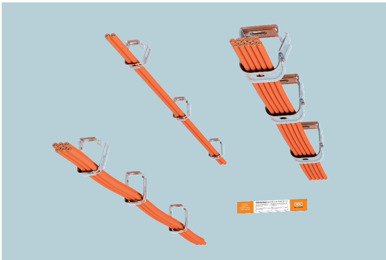
Die Kabelverlegung mit Sammelhalterungen aus Metall ist als kabelspezifische Verlegeart nach der DIN 4102 Teil 12 für die Funktionserhaltklassen E 30, E 60 und E 90 zugelassen. Die verwendeten Sammelhalterungen bestehen aus Stahlblech und lassen sich problemlos ohne Werkzeug öffnen und schließen. Während der Kabelverlegung können die Halterungen geöffnet bleiben, um ein einfaches Einlegen der Kabel zu ermöglichen. Geeignet
