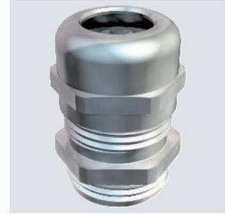
Kabelverschraubung in Hutmutterbauart mit großem Dichtbereich sowie Zugentlastung und Verdrehenschutz für hohe Dichtigkeitsansprüche, mit PG-Anschlussgewinde nach DIN 40430. Klemmeinsatz aus Polyamid, Dichtring aus Chloroprene-Nitrilkautschuk, mit vormontiertem O-Ring am Anschlussgewinde.
