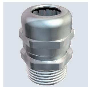
Robuste Kabelverschraubung mit metrischem Anschlussgewinde nach IEC 423 in Hutmutterbauart für hohe Dichtigkeitsansprüche. Zugentlastung, Verdreherschutz und Dichtigkeit über den gesamten Spannungsbereich. Für dickere Gehäusewandstärken in Verbindung mit Gegenmutter. Dichtring aus Neopren. Klemmeinsatz aus Polyamid. Mit vormontiertem Dichtring am Anschlussgewinde, VDE-geprüft nach DIN EN 50262, Schutzart IP68 bei 5 bar/1 h.
