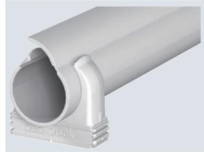
Set aus Elektroinstallationsrohren Quick-Pipe und Aufputzschellen Quick-Schelle. Zum Aufputz-Verlegen von Kabel und Leitungen im Innen- und geschützten Außenbereich. Universelle Befestigung an Wand und Decke. Umfasst abhängig vom Durchmesser bis zu 50 m Rohr zu je 2 Meter Länge und bis zu 156 Quick-Schellen. Einsetzbar im Temperaturbereich von - 25° bis + 60° C.
