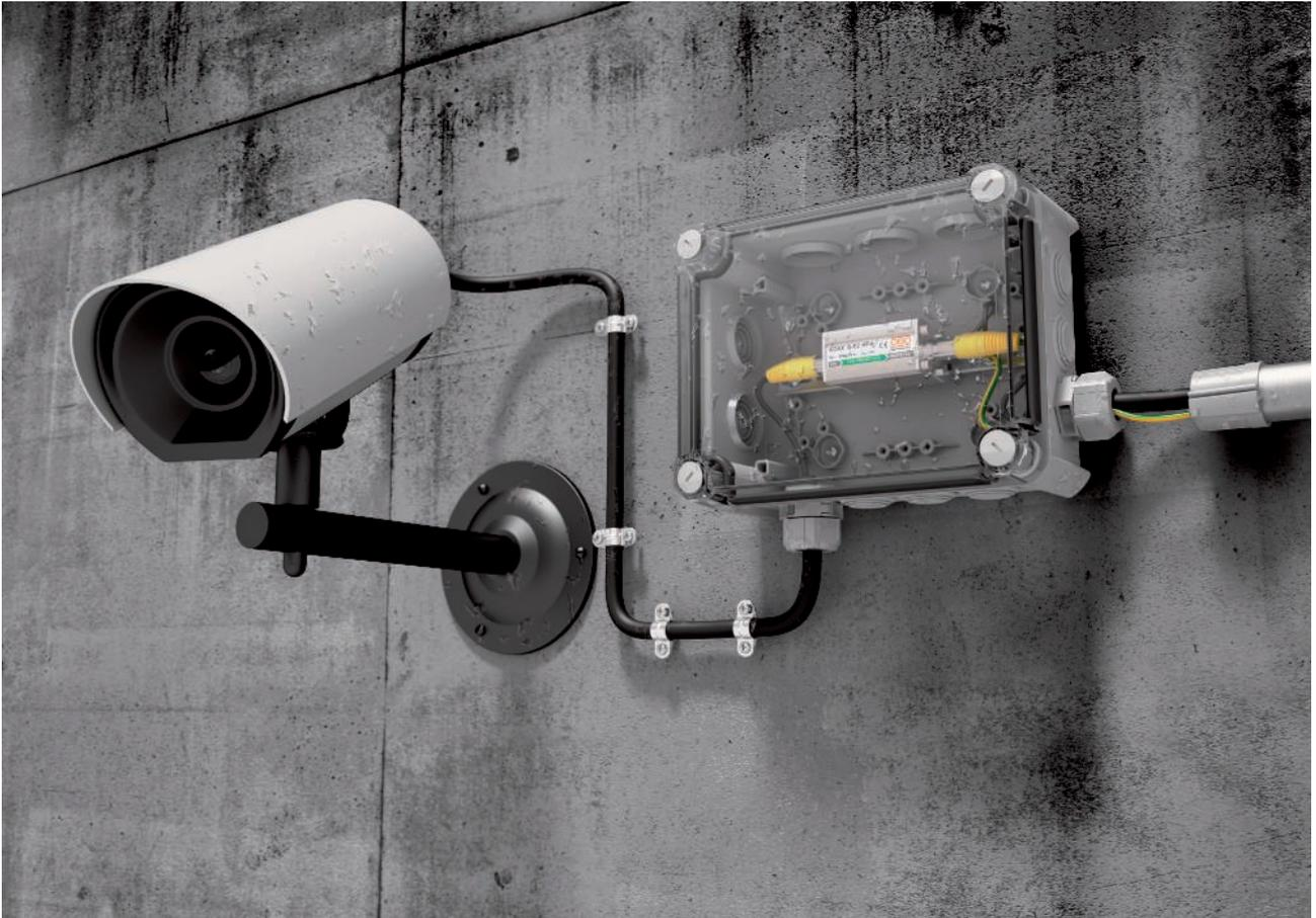
Die teilbare Kabelverschraubung ermöglicht eine problemlose und schnelle Installation z. B. von vorkonfektionierten Kabeln mit Steckern. Bei einer bestehenden Installation kann ohne Demontage und Unterbrechung eine fehlende oder defekte Kabelverschraubung ersetzt oder ergänzt werden.
