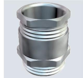
Kabelverschraubung mit Sechskant-Zwischenstutzen, Form C4 nach DIN 46320 mit metrischem Anschlussgewinde nach DIN EN 60423 bzw. ISO 68. Druckringe Stahl, galvanisch verzinkt und transparent passiviert. Dichtring aus NR/SBR. Schutzart: mit Anschlussgewinde-Dichtring IP65, ohne Anschlussgewinde-Dichtring IP54. Mit Einschnittring.
