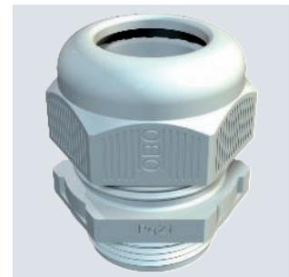
Kabelverschraubung mit PG-Anschlussgewinde in Hutmutterbauart, für Kabelabzweiggästen, Gehäuse, Verteilerkästen im privaten und industriellen Bereich. Mit Zugentlastung und integrierter Dichtlippe, geprüft nach DIN EN 62444. Schutzklasse IP68. Einsetzbar von - 20 °C bis +65 °C.
