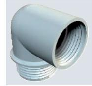
Winkelstutzen mit PG-Innen- und -Außengewinde nach DIN 40430. Der Winkelstutzen kann mit 2 Druckringen 107/D aus Stahl, einem Dichtring 107/A oder 107/B und einer Druckschraube 107/E zu einer Winkelverschraubung komplettiert werden.
