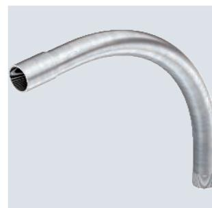
90°-Bogen für Elektroinstallationsrohre nach EN 61386-1 mit Gewindeenden nach DIN EN 60423. Mit gratfreier Innenwand. Pro Rohrbogen ist bereits eine Verbindungsmuffe aufgeschraubt.
