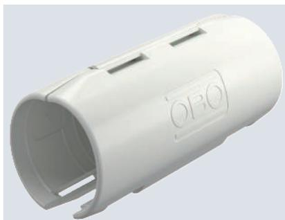
Verbindungsmuffe für Elektroinstallationsrohre aus Kunststoff zum Erstellen von Längsverbindungen. Geeignet für Rohr Quick-Pipe oder Wellrohre. Werkzeugloses Verschließen und Öffnen. Einsetzbar im Temperaturbereich von - 25° bis + 60° C.
