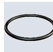
O-Dichtringe, geeignet als Anschlussgewinde-Dichtringe für alle Kabelverschraubungen aus Kunststoff und Messing mit metrischem Anschlussgewinde nach DIN EN 60423 bzw. ISO 68. Die Ringe können unverlierbar vormontiert werden.
